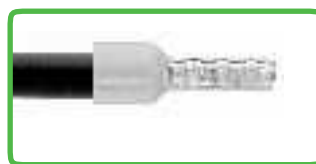
Луженый медный наконечник (герметичный обжим) Сечение клемм следует выбирать на 1 шаг больше проводника.
