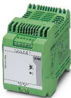
Источник питания, однофазный, 10-15 В пост. тона, 8 А,
