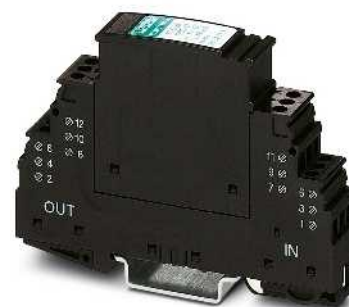
УЗИП штекерной конструкции с винтовыми зажимами, для пяти проводников, с общим опорным потенциалом
