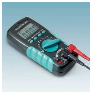
Цифровой мультиметр с электроизмерительными клещами TESTFOX... Стр. 435
