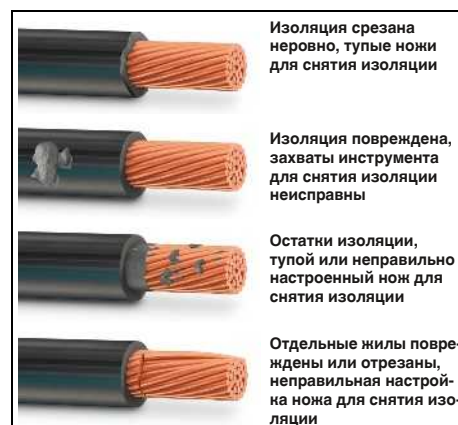
Ошибки снятия изоляции по DIN МЭК 60352
