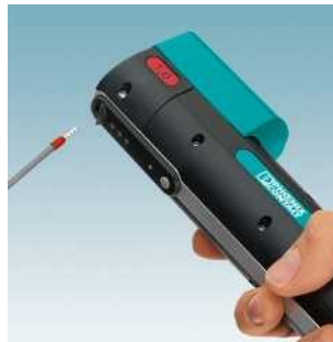
CRIMPHANDY - автоматический ручной инструмент, для снятия изоляции и обжима за один рабочий ход CRIMPHANDY Стр. 388
