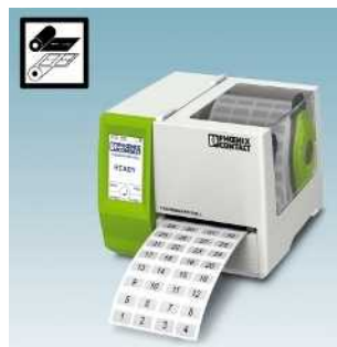
Термопечатающий принтер для рулонов THERMOMARK ROLL Стр. 38
