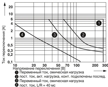
Электрическая мощность отключения для PLC...24DC/1-1/ACT с 2 замыкающими контактами
