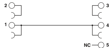
Схема подключения PLC-VT
