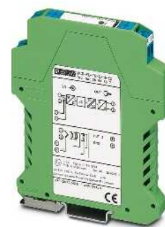
Питание от контура, возможность программирования
