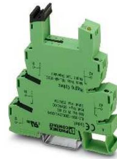
для длительных повышенных токов, 1 переключающий контакт
