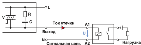
Возникновение паразитных сигналов: Вариант 1: управление - выходная плата переменного тона
