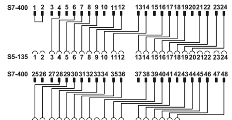
Схема подключения FLKM S135-465-4UA/UI/S400
