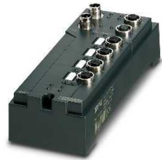
4 входа температуры для резистивных датчиков
