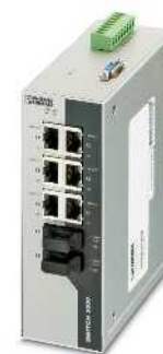
6 портов RJ45 и 2 оптических порта (одномодовые)
