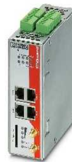
Мобильный маршрутизатор UMTS/HSPA с межсетевым экраном и VPN, встроенный 4-портовый коммутатор
