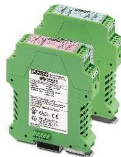
Дискретный модуль для 8 входов или выходов
