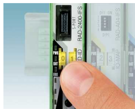
Простота адресации - вращением колёсика настройки на радиомодуле
