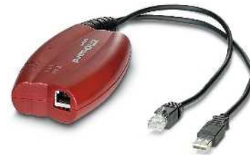
Маршрутизатор с межсетевым экраном для мобильного применения
