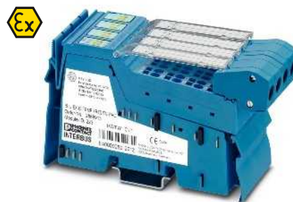
4 входа с возможностью выбора, RTD или ТС
