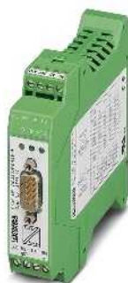
Преобразователь RS-232 для RS-422 и RS-485, 2 канала
