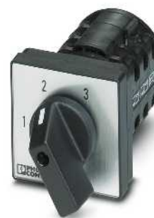
2,5 (2,5) мм 2 , 20 А, ступенчатый переключатель без положения 0
