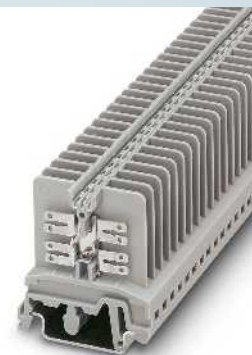
4 (6) мм 2 , 32 А, проходная клемма, с плоскими контактами
