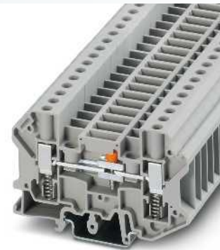
6 (10) мм 2 , 57 А, клемма с размыкателем для измерительного трансформатора
