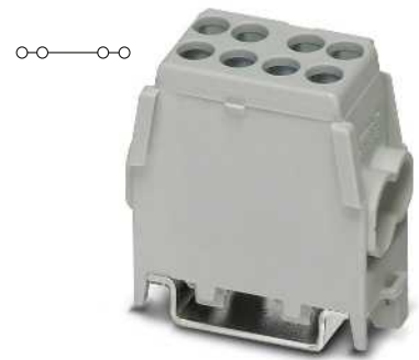
25 (25) мм 2 , 101 А, распределительная клемма, 2 отвода по 16 мм 2
