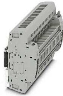
6 (10) мм 2 , 30 А, 4 ... 25-конт. базовый блок, установка на монтажную рейку, винтовой зажим
