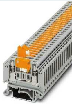
2,5 (4) мм 2 , 16 А, клемма с ножевым размыкателем, винт с тестовым гнездом
