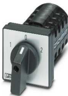
2,5 (2,5) мм 2 , 20 А, переключатель с положением 0
