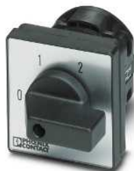
2,5 (2,5) мм 2 , 20 А, ступенчатый переключатель с положением 0
