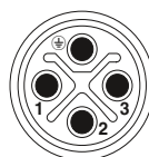
Расположение контактов штекера M12, 4 полюса, с механическим ключом типа S, вид со стороны штыревой части
