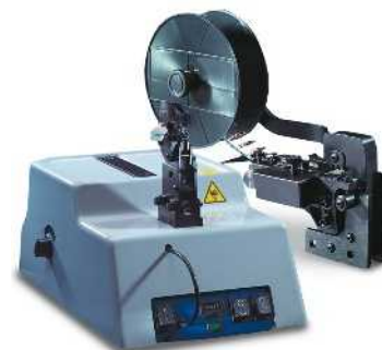
Электрический обжимной инструмент для штампованных-скрученных обжимных контактов С-НС
