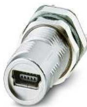
Mini-B USB, крепежная резьба M12, контакты для пайки волной припоя, встроенный контакт для экранирования
